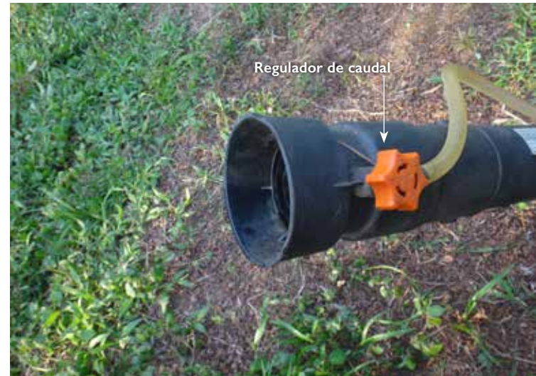
Figura 2. Equipo motorizado de espalda, apto para aspersiones en plantaciones menores a seis años.
