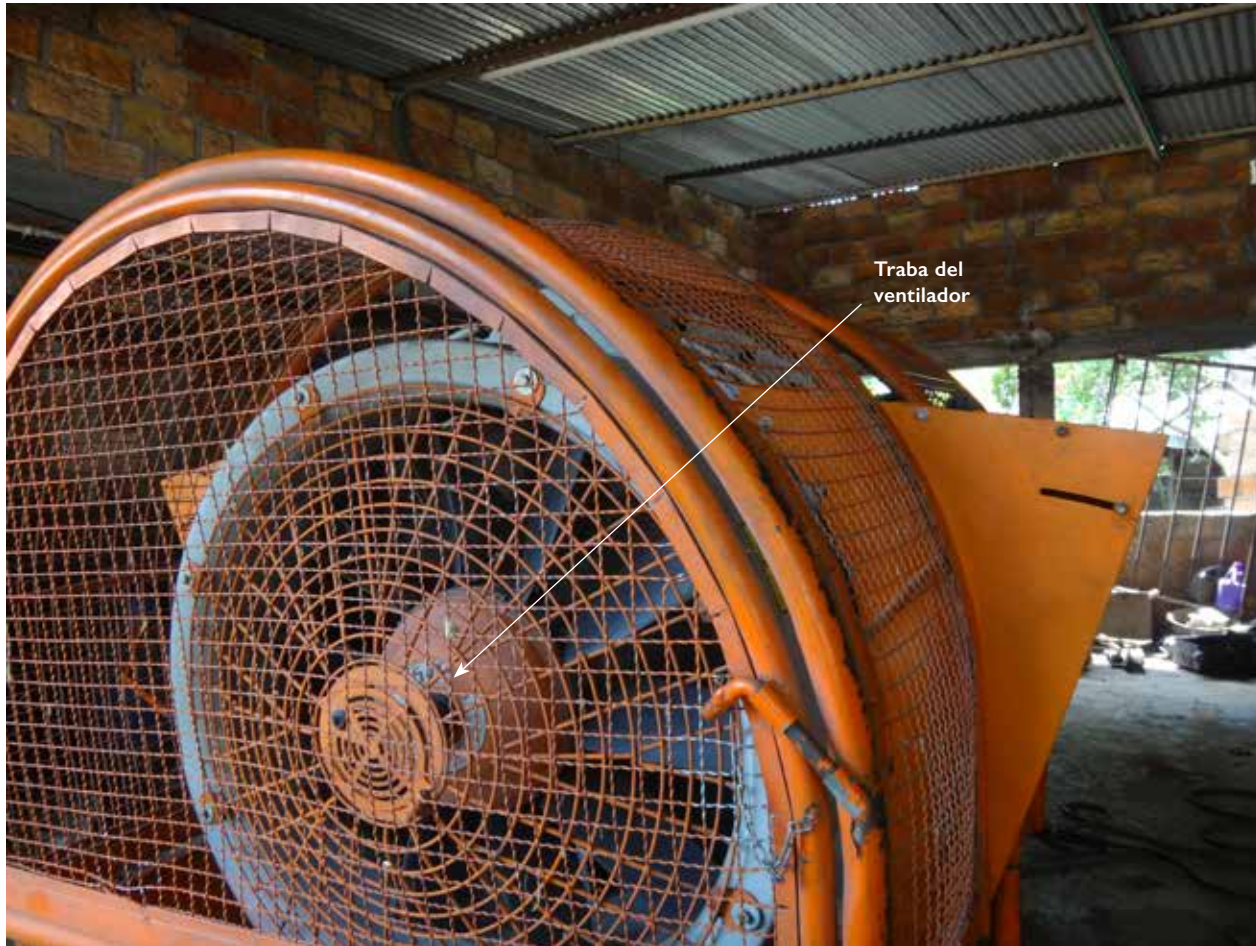
Figura 13. Localización de la traba del ventilador de una pulverizadora agrícola Jacto Arbus 400 Golden.
