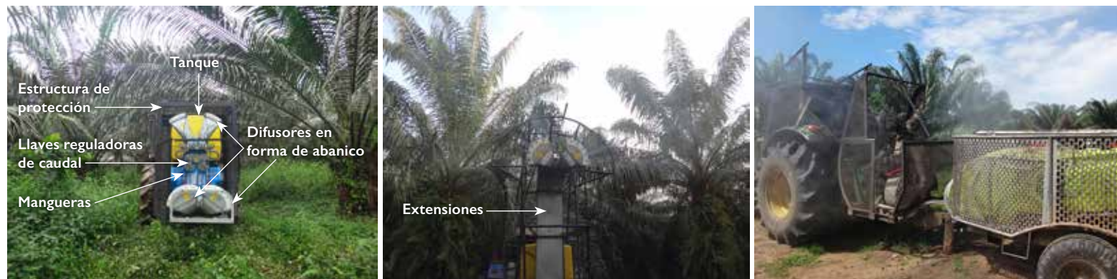
Figura 6. Equipos nebulizadores electrostáticos utilizados para aspersiones foliares en palmas de diferentes edades.
