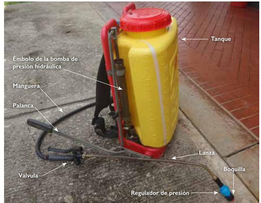
Figura 1. Equipo de aspersión manual de espalda, utilizado en plantaciones de palma de aceite.
