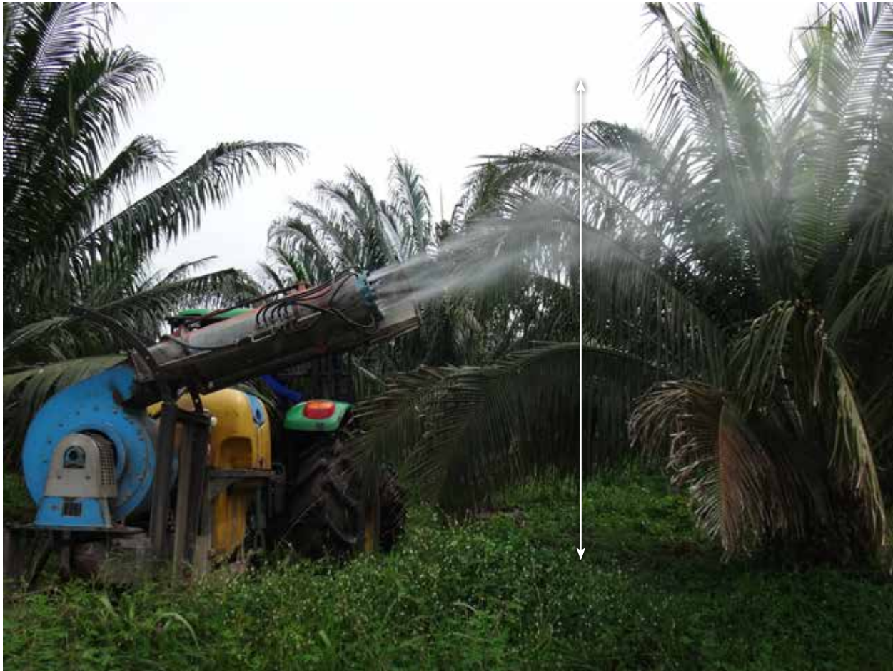
Figura 10. Movimiento vertical de la nebulizadora electrostática con cañón que permite obtener un adecuado cubrimiento en aspersiones foliares en cultivares híbridos OxG de palma de aceite.
