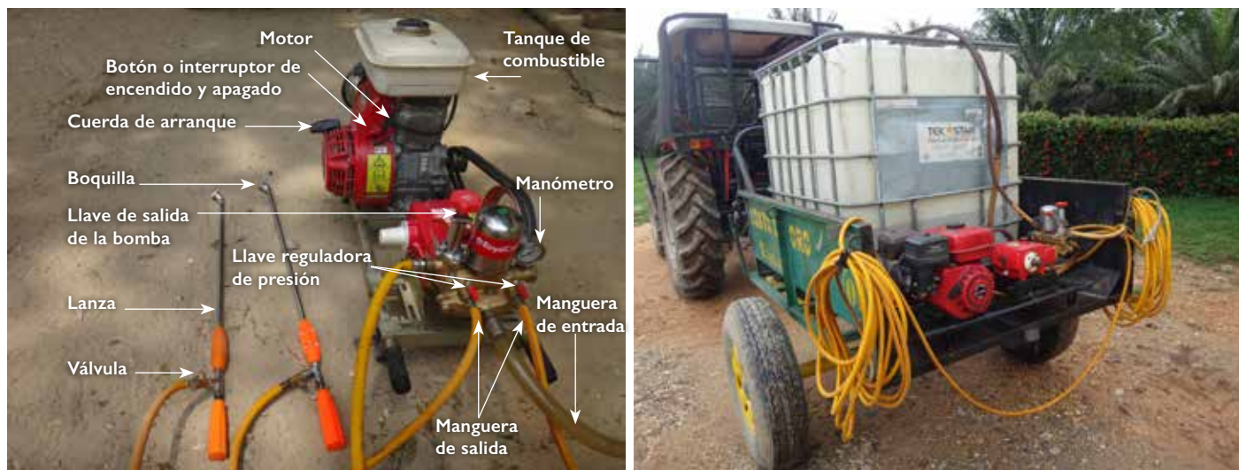
Figura 5. Equipo estacionario utilizado en palmas de aceite. A. Partes de un equipo estacionario. B. Disposición de estacionaria en remolque de tractor.
