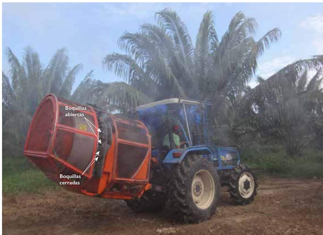
Figura 14. Selección de boquillas para la aspersión de acuerdo con la altura de la palma.
