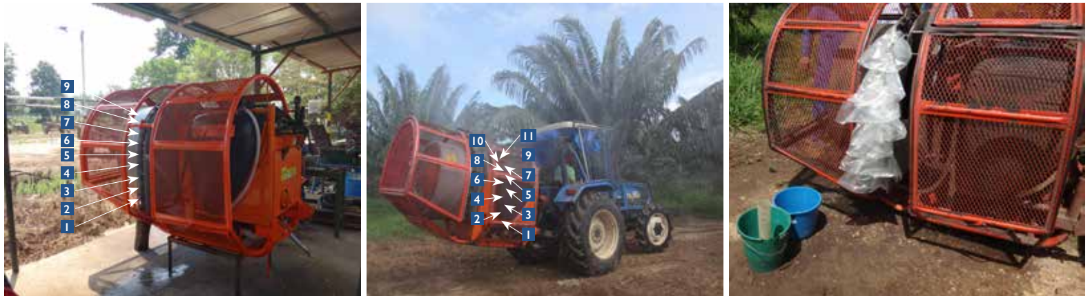
Figura 12. Numeración de las boquillas del equipo en cada uno de los costados y bolsas aseguradas en cada boquilla para determinar su descarga.
