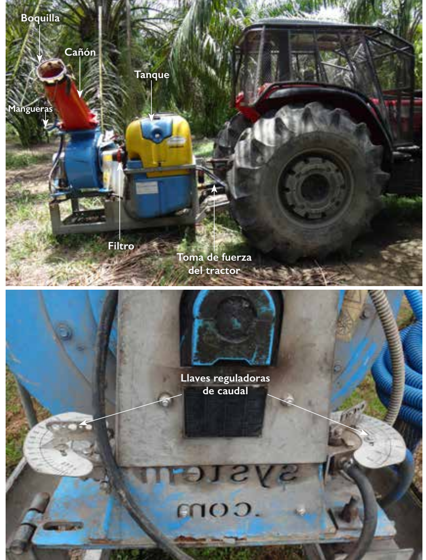
Figura 9. Nebulizadora electrostática con cañón utilizada en el cultivo de palma de aceite.
