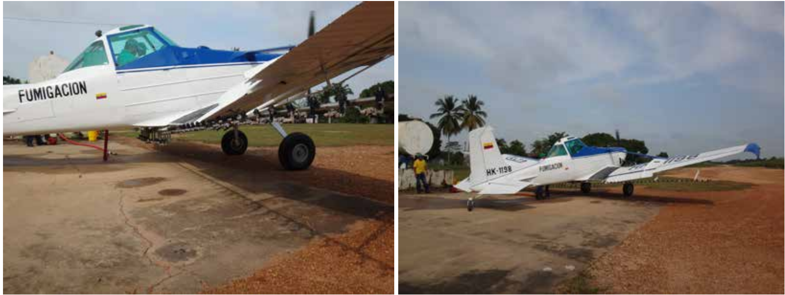
Figura 15. Equipo aéreo utilizado en aspersiones foliares de grandes extensiones de palma de aceite.
