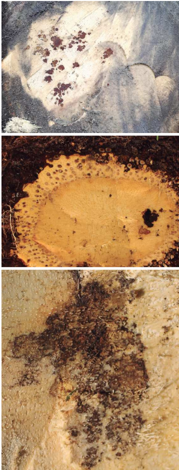
Figura 22. Lesiones iniciales. Pudrición seca de calor marrón oscuro con zona de avance de color crema-amarillo.
