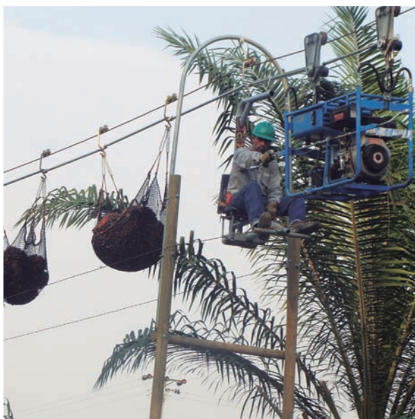
Figura 53. Transporte de fruto en cablevía. El Palmar de La Vizcaína. Foto: Nolver Arias.
