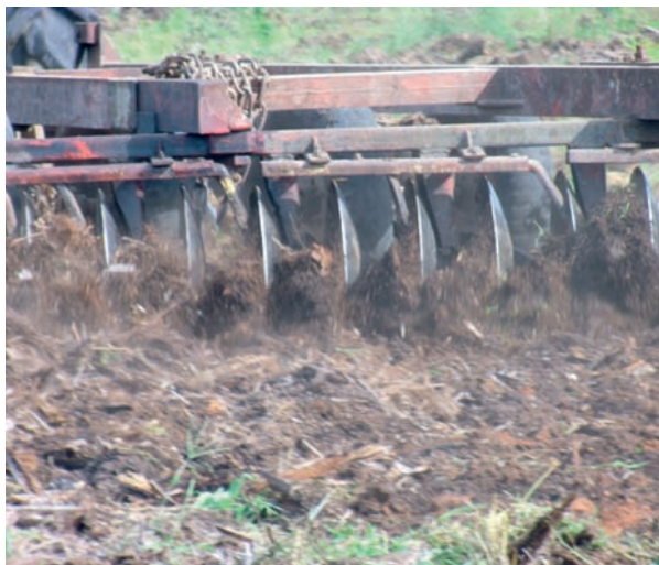
Figura 28. Adecuación física de suelos por medio de arado de disco en una plantación de la Zona Oriental. Foto: Carlos Mauricio Saavedra.
