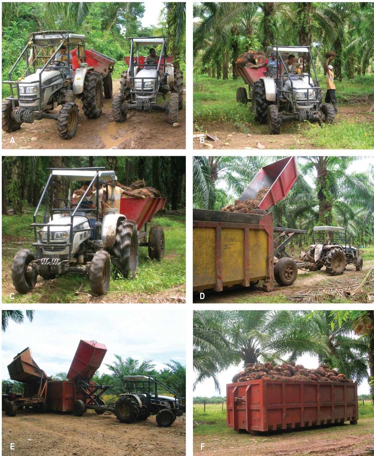
Figura 1. Operaciones realizadas por la cuadrilla de recolección: (A) desplazamiento a los lotes de cosecha; (B) recolección de los racimos y fruto suelto; (C) desplazamiento al punto de acopio; (D y E) descargue de los racimos de fruta fresca en el punto de acopio; (F) la caja contenedora lista para su transporte a la planta extractora.
