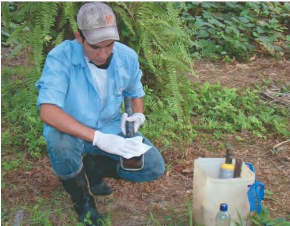
Figura 13. Aplicación uniforme de hipoclorito de sodio con la ayuda de servilleta y limpieza del palín luego de aplicado el hipoclorito.
