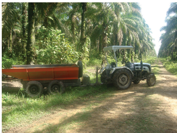
Figura 9. Tractor con zorrillo hidráulico.
