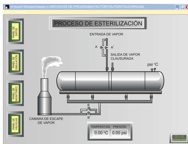
**Figura 23.** Pantalla de visualización del proceso de esterilización.
