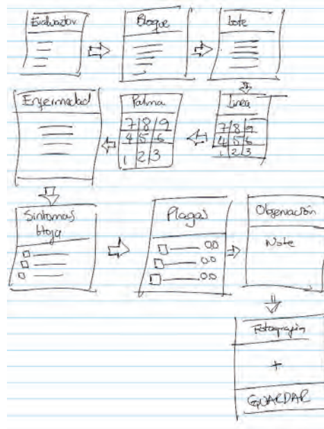
Figura 11. Diagrama de secuencia de pantallas diseñadas para el seguimiento de plagas y enfermedades
